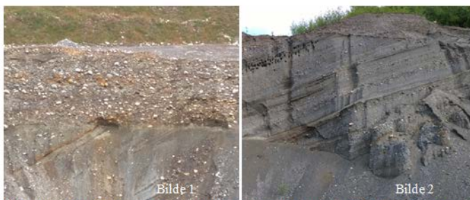
Figur 2 Grovt materiale i topplag (Bilde 1), sorterte masser i skrålag mot dyptet (Bilde 2) (lokalisering i figur 1)
